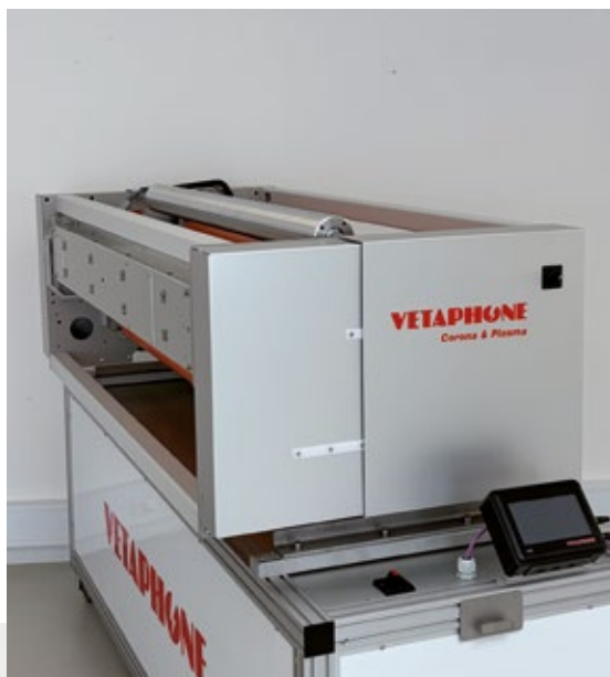
VE2C-K di Vetaphone per film in bolla, mostrato con rulli di guida opzionali / Vetaphone VE2C-K corona treater for blown film shown with optional guide rollers
