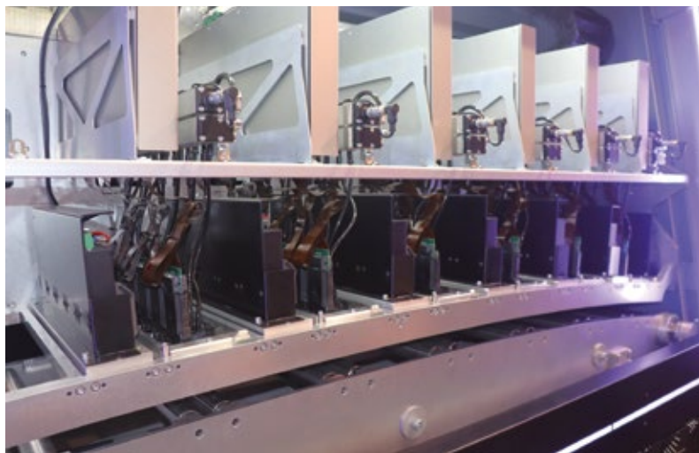
Serie di testine di stampa CMYK con arancione e viola / CMYK printhead array with orange and violet (Source: pack.consult)
