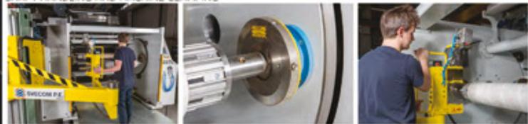
Il nostro mod. 10 semplifica il carico e lo scarico di alberi espansibili in modo **sicuro e senza sforzo**. Disponibile assieme a carrelli per ottenere una soluzione di movimentazione **semiautomatica**.
