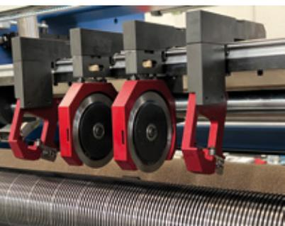
Completamente meccanico e pensato per garantire massima precisione, si contraddistingue per la sua flessibilità: taglio minimo di 20 mm, una semplice regolazione della profondità e dell'angolo di taglio, posizionamento automatico dei coltelli e semplice intercambiabilità tra taglio a forbice e lametta (sia in aria che nella cava).
