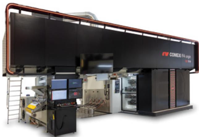
grafiche compatte, debutta con una velocità fino a 400 m/min e larghezze di stampa a partire da 240 mm. Sistemi evoluti come GeniusRun e GeniusDry assicurano qualità di stampa eccellente ed efficienza energetica.
