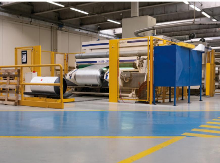
realizzazione di film bilaccati, applicando lacche differenziate su ciascun lato per ottenere funzionalità distinte. Le formulazioni utilizzate da Metalfilms garantiscono elevata resistenza chimica e meccanica, mantenendo al contempo la compatibilità con i processi industriali a valle. La metallizzazione a bande rappresenta una soluzione altamente tecnica per applicazioni in cui è richiesta
