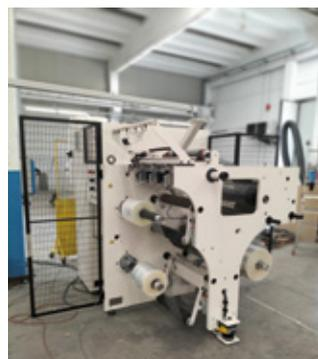
za alberi a frizione per un taglio e un avvolgimento di precisione, garantendo un controllo ottimale della tensione e bobine perfettamente avvolte.
