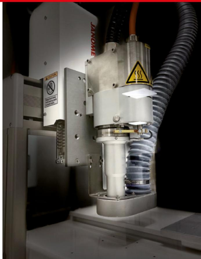
**Il sistema applica il plasma su un supporto, modificando così le sue caratteristiche superficiali / The system applies plasma over a substrate, thus changing its surface properties**
