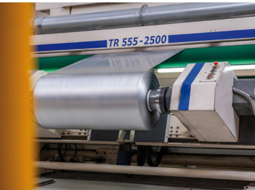
film proprietà uniche, migliorando la barriera ai gas, alla luce e l'isolamento termico, a seconda delle necessità applicative. Tra i servizi più evoluti offerti vi sono anche l'ALOX, che consente di ottenere film con eccellenti proprietà barriera pur mantenendo la trasparenza, la laccatura, studiata per esaltare le performance della metallizzazione, migliorando la barriera ossigeno, la
