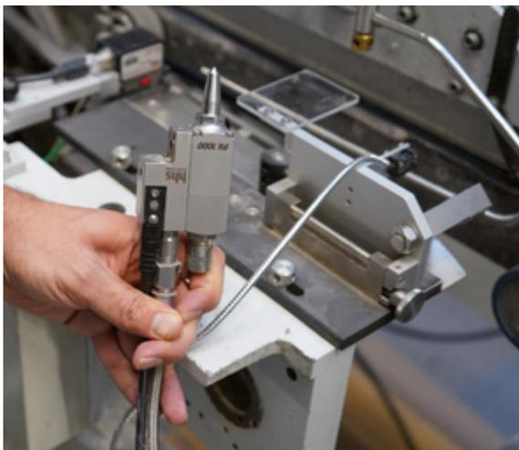
zione PX 1000 offre la massima precisione e giunzioni incollate in modo pulito, applicando l'adesivo con una striscia di colla continua, punti intermittenti di lunghezza definita o punti. Con questo tipo di flessibilità nel processo di incollaggio, il consumo di adesivo può essere ridotto fino al 50% a seconda dell'applicazione.
