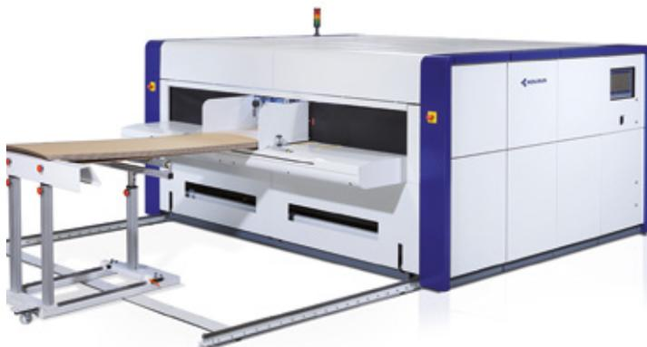
per soddisfare le esigenze delle aziende nel campo dell'imballaggio. Si tratta di una macchina che utilizza un sistema automatizzato per tagliare piegare e incollare le scatole, riducendo notevolmente i tempi di produzione rispetto ai metodi tradizionali.
