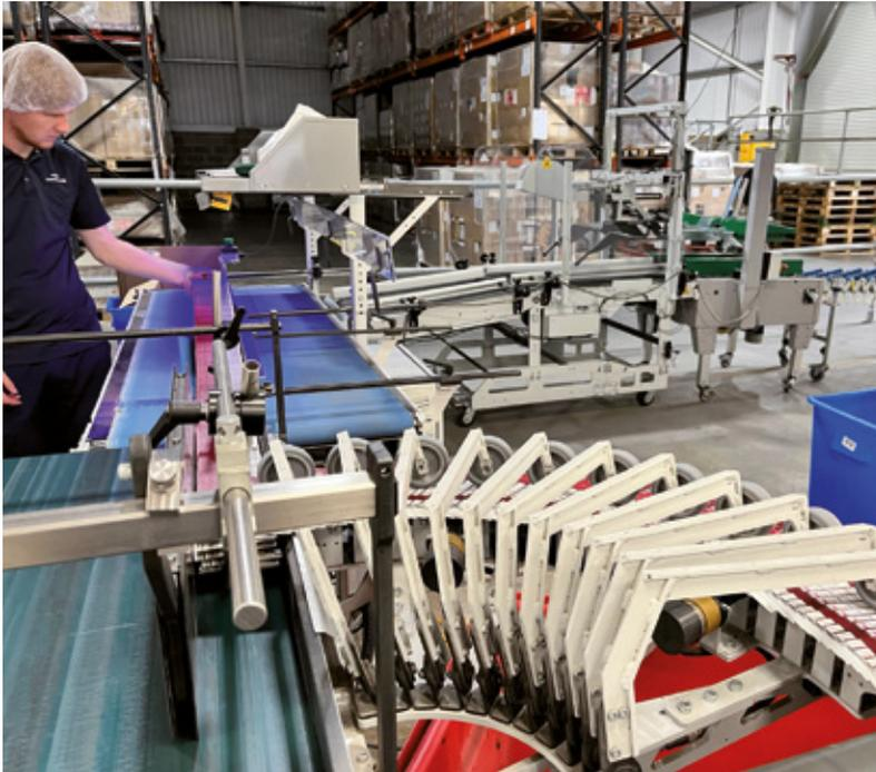
**Soluzione di confezionamento modulare Impack Ergosa con gira-scatole, scaffale per accessori, trasporto ad accumulo e sistema integrato di gestione degli scatoloni presso Cartonage nel Regno Unito / Impack Ergosa modular packing solution with box turner, accessory shelf, accumulation conveyor and integrated case management system at Cartonage in the UK**
