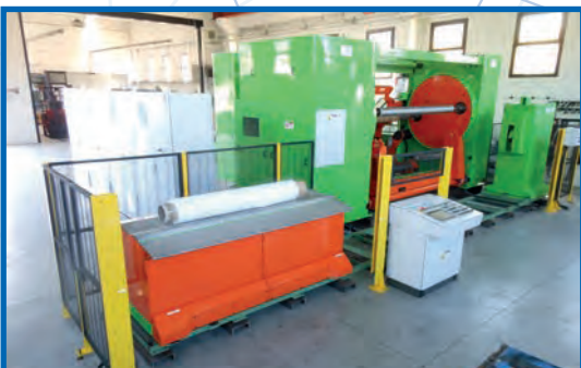
Avvolgitore automatico con leve di scarico e sfilamandrino
