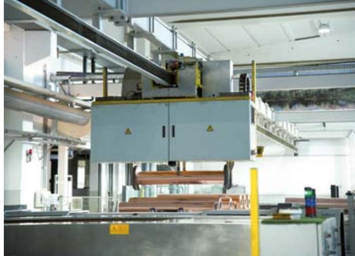
di una nuova macchina di finitura del rame post incisione. Quando l'incisione del cilindro rotocalco avviene su acciaio, una volta terminata l'incisione, si passa alla sabbiatura ed eventuale cromatura ma la lavorazione è praticamente ultimata; quando invece si lavora il rame c'è bisogno di un ulteriore passaggio di finitura, che ICR ha da poco inserito nel suo reparto di produzione.
