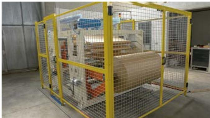
teriale in avvolgimento senza adesivi fino alla velocità di 300 m/min; possibilità di svolgere il materiale in front e/o reverse.
