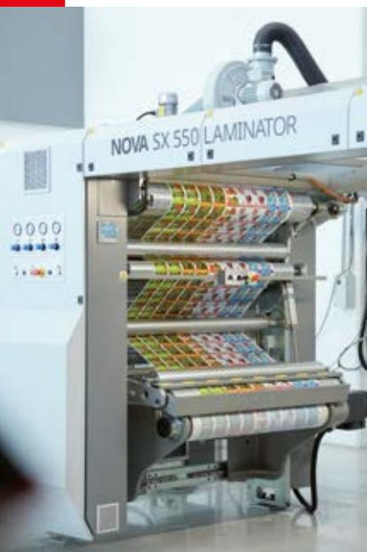
di ottenere risparmio energetico grazie alla possibilità di ridurre i volumi d'aria. L'uniformità dell'essiccazione è garantita su tutta la larghezza del materiale e viene ridotto l'effetto pelle o raggrinzamento unitamente a una bassa ritenzione di solvente.
