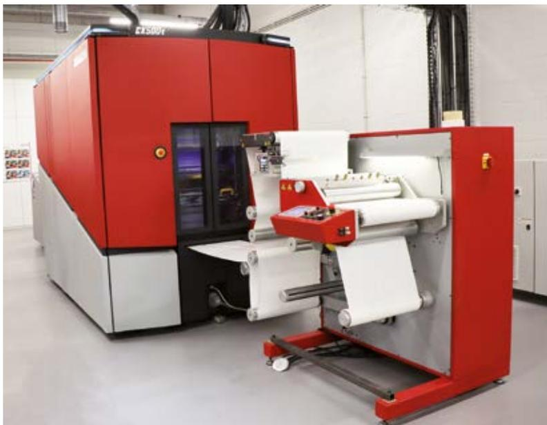
**La Xeiikon CX500t è dotata di un'unità di trattamento LED per reticolare il toner TITON / The Xeiikon CX500t has an LED curing unit for crosslinking the TITON toner (Source: pack.consult)**
