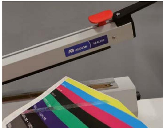
**Gli strati di toner tradizionale hanno una resistenza insufficiente alla sigillatura quando si tratta di imballaggi flessibili, così non accade con il toner a secco Titon / Conventional dry toner layers have insufficient seal resistance for use in flexible packaging, in contrast to TITON dry toner (Source: pack.consult)**
