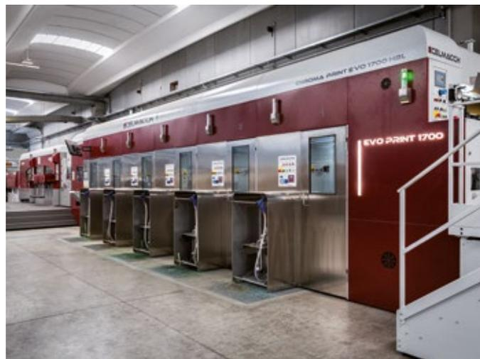
ponenti elettronici di primaria qualità per garantire massima affidabilità, precisione di stampa e robustezza della linea. I motori diretti sono alimentati tramite unità di potenza rigenerative, che permettono di recuperare parte dell'energia cinetica dissipata durante le fasi di frenatura, trasformandola in energia elettrica, con un significativo contenimento dei consumi. La struttura del sistema elettrico è modulare, al fine di ridurre i costi e i tempi di manutenzione, ca-
