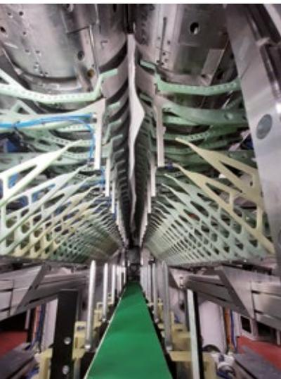
del prodotto. Sostituendo un solo cassetto, infatti, è possibile cambiare in modo semplice, veloce e automatizzato il formato del taglio senza compromettere la qualità del prodotto finito. Soluzione ideale per quelle realtà che necessitano di sviluppare interfogliati di lunghezze differenti senza perdere OEE. Brevettata da Körber Business Area Tissue Fold, la MTC ITF Change ha solo due rulli di piegatura al cui interno è inglobata anche la funzione di taglio.
