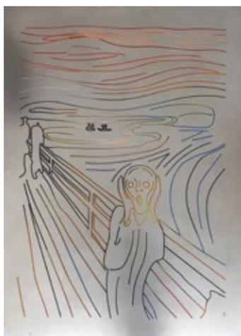
**Urlo di Munch: piastra fresata con canaline smussate. Tecnologia utilizzata per produrre cordonature performanti senza creare microforature. Raccomandato per imballo alimentare e contenitori di liquidi / Munch's Scream: milled plate with chamfered channels. Technology used to produce performing creasing without creating microperforations. Recommended for food packaging and liquid containers**
