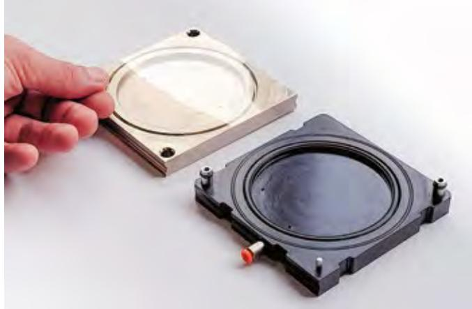
**Le misurazioni mostrano che l'OTR per un film con la vernice barriera all'ossigeno di hubergroup è inferiore a 10 centimetri cubici di ossigeno per metro quadrato e giorno (Fonte: hubergroup) /**
