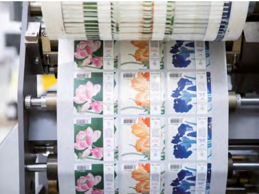
finitura è automatizzato digitalmente per tempi di attività eccezionalmente elevati, scarti ridotti e ripetibilità eccezionale indipendentemente dalle capacità dell'operatore. Il controllo qualità è garantito da Bobst Accucheck per un'ispezione in linea al 100% a velocità massima.
