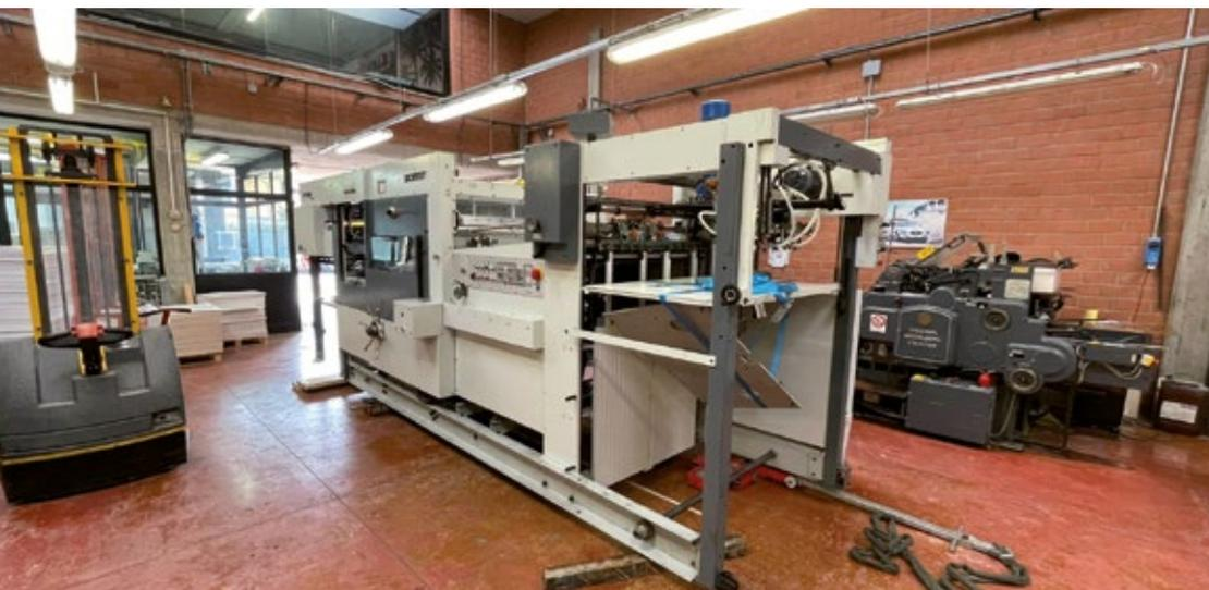
“Dopo un’attenta analisi da parte di Sergio Bocchio delle necessità del cliente, si è ritenuto ottimale proporre la Bobst SP 102 prevedendo nell’immediato futuro anche l’installazione di una piega incolla sempre revisionata”, aggiunge Camporese. La Bobst è stata sottoposta a una revisione a zero copie in Officina, sostituendo tutte le componenti della macchina trovate usurate, con nuovi ricambi per garantire la massima resa e affidabilità.
