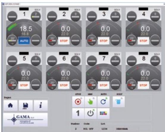
**Interfaccia software di sistema di controllo e correzione della viscosità 8 colori / Software interface of a system to control and correct viscosity, 8 colors**
