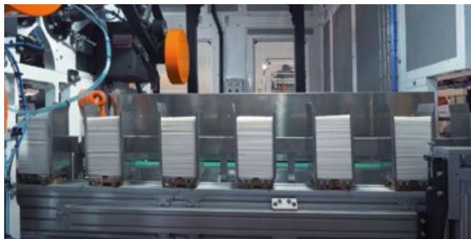
va la necessità di avere un tovagliolo specificatamente pensato per avvolgere i tacos. Da questa esigenza e dalla collaborazione tra ufficio commerciale, ricerca & sviluppo e i tecnici specializzati è nato l'optional taquera, una soluzione estremamente versatile installabile sulle linee MTC ITF omni che permette di produrre con un'unica testa di piega tutti i prodotti interfogliati, compreso il tovagliolo per tacos", commenta Stefano Anelli, Sales Manager Körber Business Area Tissue Fold.
