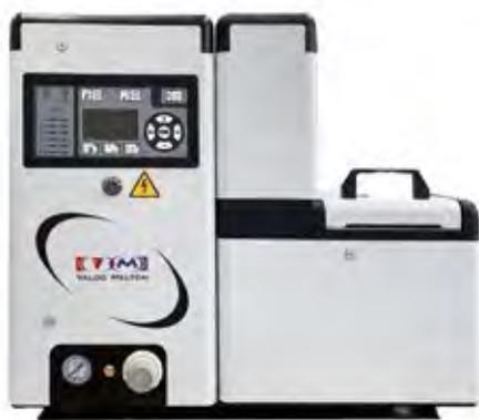
elettrico EcoStitch, già noto nel settore dell'imballaggio per la sua lunga durata ed efficienza. Basato su un controllo preciso dell'erogazione dell'adesivo, produce punti adesivi molto precisi e riduce l'utilizzo di adesivo fino al 75%. Nelle linee ad alta velocità, EcoStitch si ripaga in meno di tre mesi.
