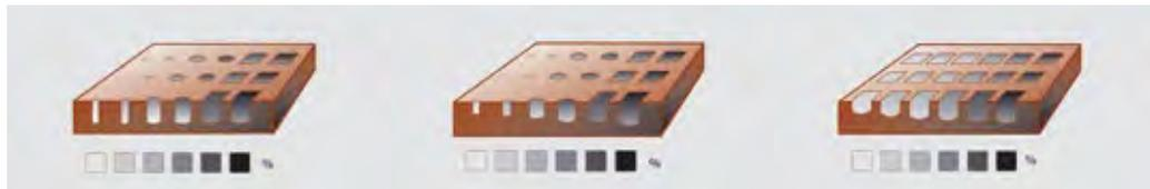
**Nella stampa rotocalco, la struttura del retino può essere in linea di principio semi-autotipica (sinistra), convenzionale (centro) o autotipica (destra). Mentre l'Helioklischograph incide sempre in modo semi-autotipico, il Cellaxy invece consente una struttura del retino variabile sia in profondità e/o area, quindi può riprodurre tutti e 3 le tipologie /**
