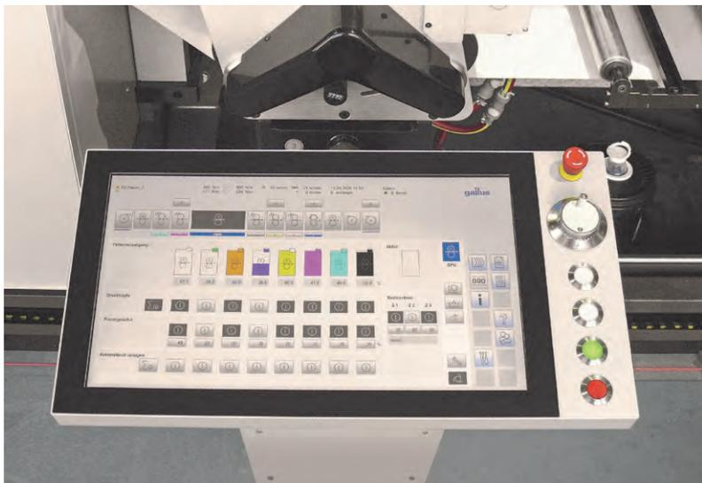
**Il pannello di controllo con schermo a contatto permette agli operatori di visualizzare direttamente l'immagine stampata e controllare le funzionalità della macchina ibrida da un unico punto. / The HMI touch screen control panel allows the operator to view the print image directly and control the hybrid press's functionalities from a single point (Source: Gallus Ferd. Rüesch AG).**
