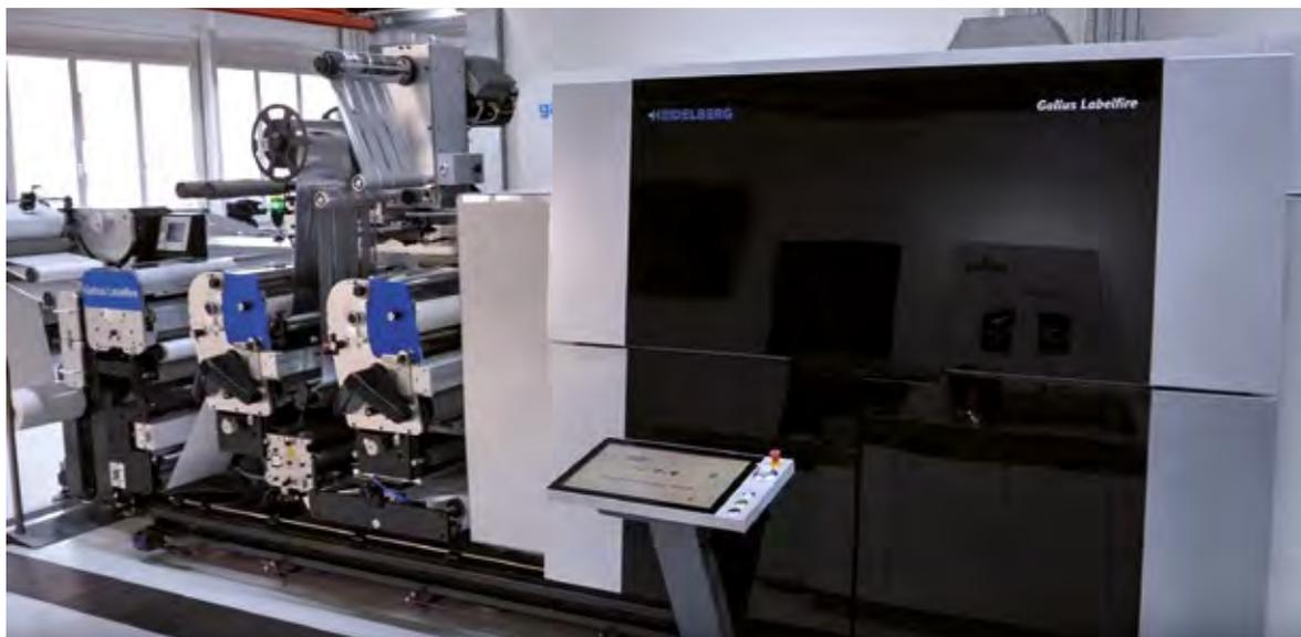
**Gallus Labelfire, dotata di due unità flexo prima dell'unità digitale inkjet UV a 7 colori più il bianco / Gallus Labelfire with two flexo printing units before the UV inkjet digital printing unit with 7 colours plus white (Source: Gallus Ferd. Ruesch AG).**
