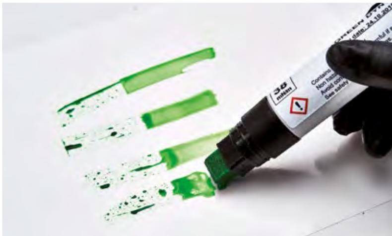
**Man mano che i trasformatori passano da inchiostri e vernici a base solvente a quelli a base acqua, la necessità di eseguire il dyne test diventa più importante in quanto è necessaria una maggiore tensione superficiale e ciò richiede un trattamento corona di maggiore potenza / As converters switch from solvent to water-based inks and lacquers, the need to dyne test becomes more crucial as greater surface tension is needed, and this demands higher power corona treatment**
