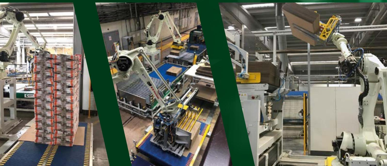
Palettizzatori robotizzati per top/bottom printing case-makers, palettizzatori robotizzati per fustellatori, palettizzatori robotizzati per linee piegaincolla.
