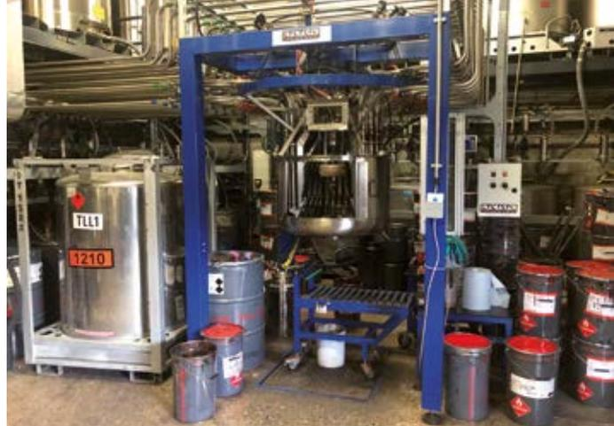
colori partendo dalle basi, un impianto di alimentazione automatico su tutte le linee di stampa per quanto riguarda l'acetato, il solvente e il bianco, e infine l'impianto di recupero del solvente sporco, che dopo essere distillato viene utilizzato per il lavaggio delle macchine.
