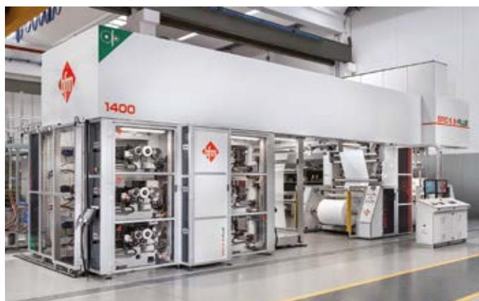
Arabia Saudita, precisamente una a 6 e una a 8 colori, consolidando così la sua presenza in Medio Oriente. Il modello Sirio è una macchina “Stack type” a 6/8 colori, progettata per la stampa su diversi materiali plastici per il mercato del packaging ma adatta anche per materiali cartacei, in linea
