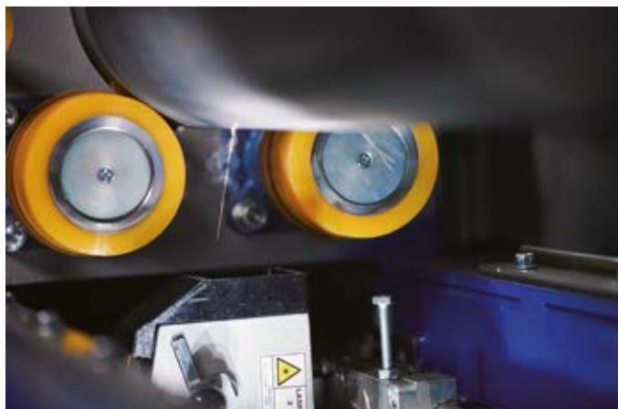
stesso, dando vita a programmi di pulizia personalizzati. Questo consente a Evolux di rimuovere non solo gli inchiostri, ma anche residui più difficili come vernici, adesivi e silicioni, a base solvente, acqua o UV. Una volta effettuato lo start up attraverso il monitor touch screen integrato da 21”, il processo di pulizia avviene in modo veloce, silenzioso e interamente automatizzato, senza alcuna necessità di controllo da parte dell'operatore e sempre con la garanzia della massima efficacia.
