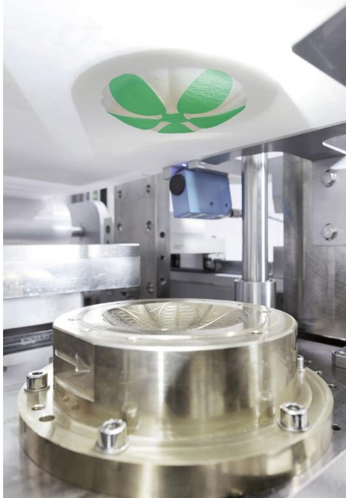
Utilizzando la tecnologia di termosaldatura, il contenitore in carta sagomata può essere sigillato con qualsiasi materiale di copertura termosaldabile; le barriere saranno completamente personalizzate in base alle esigenze del cliente.
