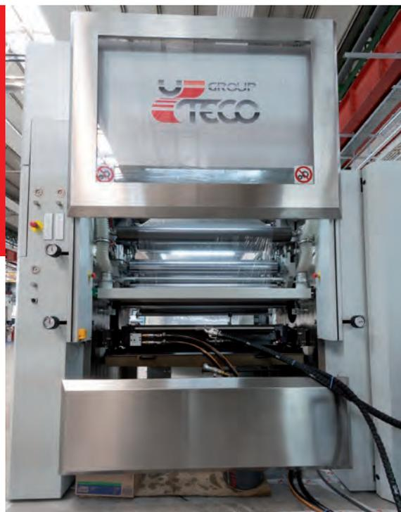
macchina, tanto tecnologica quanto semplice, come evidenziato dal percorso del materiale. "La macchina è composta da 2 teste di spalmatura, l'unità di laminazione, 2 avvolgitori e 1 avvolgitore. Tutto il processo parte dall'unità solventless dove sono presenti 2 rulli in acciaio per dosare il gap e l'adesivo, 1 sleeve facile da gestire e molto rapida per i cambi lavoro per il trasferimento
