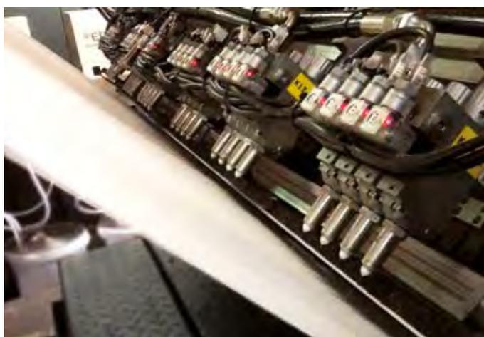
**I sistemi elettronici facilitano l'eliminazione degli ingombranti sistemi a rullo, riducendo l'uso di adesivo nonché la manutenzione e lo smaltimento e relativi costi / Electronic systems allow manufacturers to finally get rid of messy open glue pots, reducing adhesive usage and maintenance**
