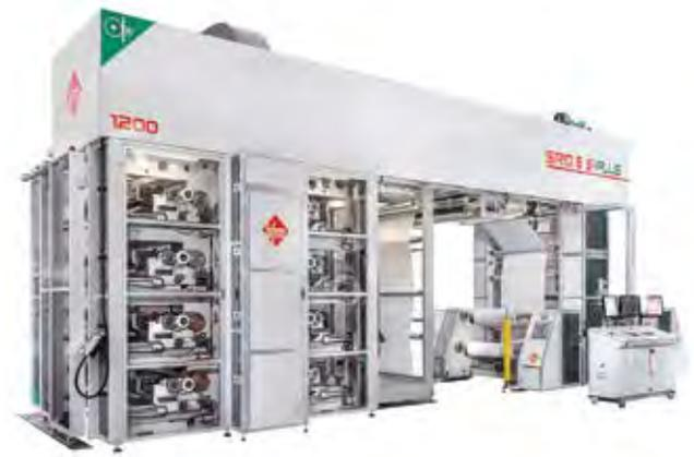
revolver, gruppo di stampa a 6/8 colori con asse di controstampo motorizzato, macinazione elettrica e inchiostrazione pneumatica. Il gruppo di asciugatura è composto da sistema intercolor e cappa di asciugamento con riscaldamento a gas o elettrico e avvolgitore con diverse possibilità di avvolgimento. La velocità massima di produzione è di 250 metri al minuto.
