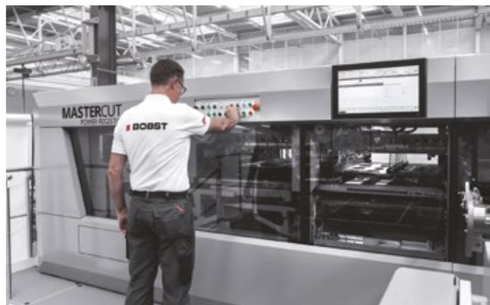
un intervento minimo dell'operatore. Le nuove funzioni di automazione permettono una riduzione significativa del tempo di impostazione di 15 minuti. Gli utensili di estrazione sfridi e fustellatura, ad esempio, come anche la griglia non stop all'uscita vengono impostati automaticamente.
