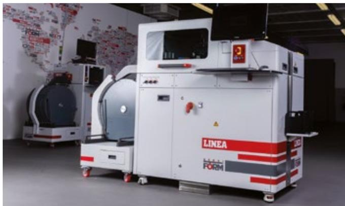
Linea utilizza un sistema di piegatura derivato da quello in uso su EcoPlus che, grazie ad un nuovo sistema di bloccaggio del filetto, permette di spingere la velocità di piega a livelli impensabili per le macchine precedenti: 33% più veloce di EcoPlus!
