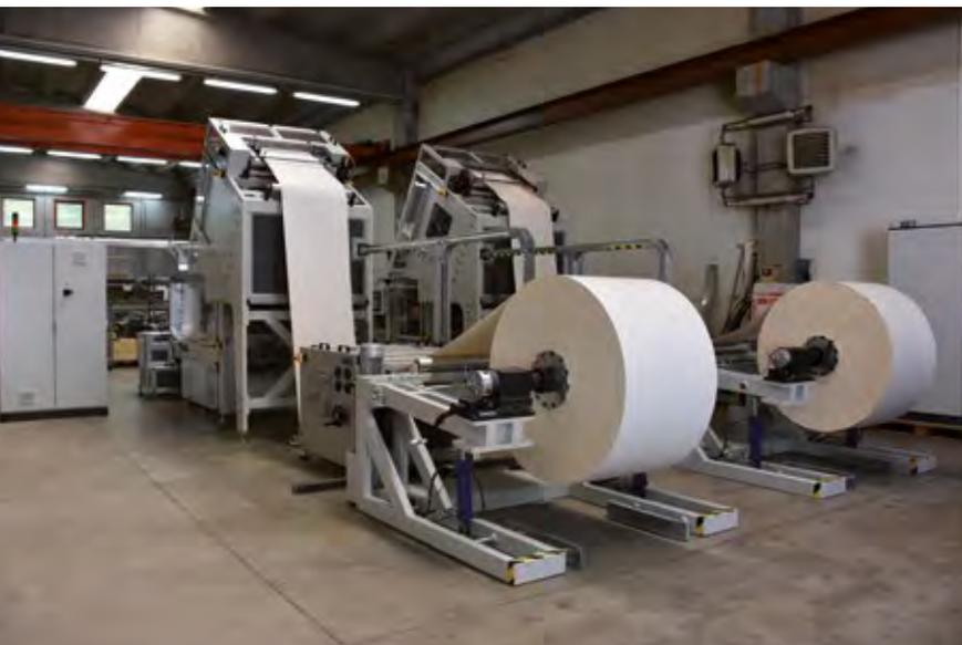
**La macchina termofornatrice da bobina, Novatec PV 85**
