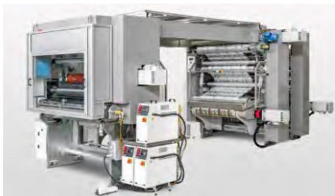
qualsiasi lunghezza di tiratura su una vasta gamma di materiali flessibili di tipo e spessore diversi. Il design modulare la rende configurabile con rulli di trasferimento, oppure con maniche o rulli monolitici/integrali.
