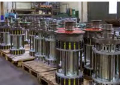
La testata targata Svecom P.E. garantisce una autocentratura ottimale: grazie ai suoi 20 mm di espansione sul diametro, può essere facilmente inserita all'interno dell'anima.
