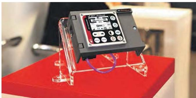
**ekr CON 600 di BST eltromat è un nuovo controller con una tecnologia orientata al futuro, aperta alle nuove richieste di integrazione. L'architettura del sistema consente di incorporare vari sistemi fieldbus senza modificare i sistemi operativi e di connessione**
