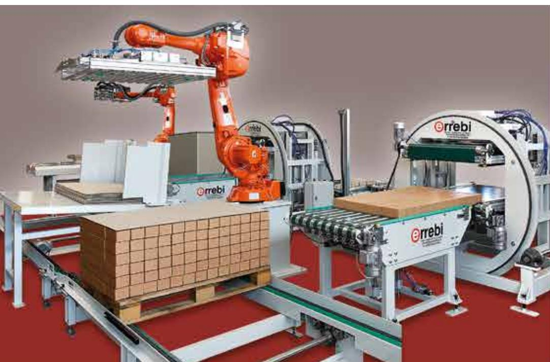
Impianto robotizzato per produzione Paper Pallets
