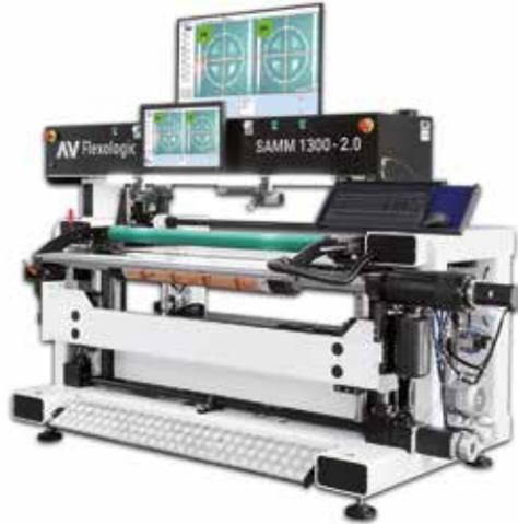
che assicuri la massima precisione, uniformità e costanza, fino a 5 micron per lastra; fino a 10 volte più veloce rispetto al montaggio tradizionale; 3 volte più veloce del montaggio automatico della lastra di prima generazione e nessuna dipendenza dall'operatore.
