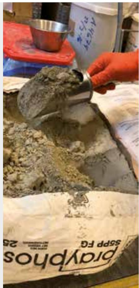
dell'industria del cemento in fatto di peso totale, livello di idratazione, resistenza della malta, scorrimento iniziale o resistenza alla compressione a 28 giorni. «Lo studio dimostra che se si desidera stoccare il cemento per un periodo di 18 mesi, i sacchi di carta forniscono buone prestazioni di shelf life. Proteggono perfettamente la qualità e le proprietà dei vostri prodotti», sintetizza Catherine Kerninon.
