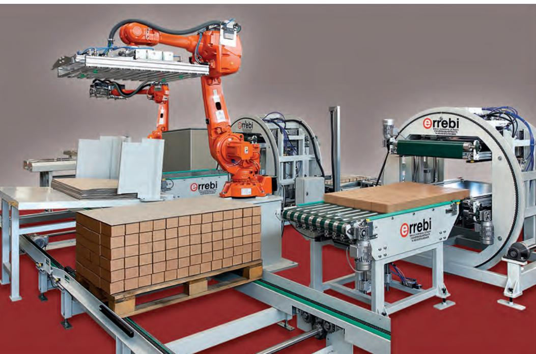
Impianto robotizzato per produzione Paper Pallets
