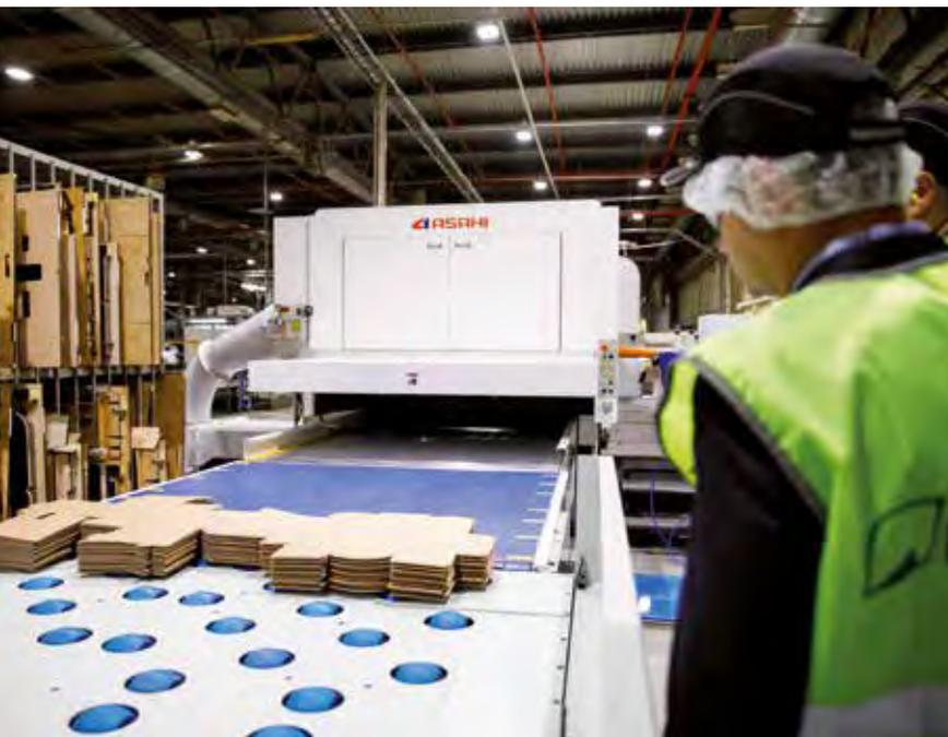
Il sistema di cambio dei cilindri anilox permette a Ilim di beneficiare di una serie diversificata di anilox, per produrre un'ampia gamma di prodotti. La configurazione HBL e l'elevata tecnologia di Celmacch garantiscono un altissimo livello di automazione e i tempi per il cambio di lavoro sono ridottissimi.
