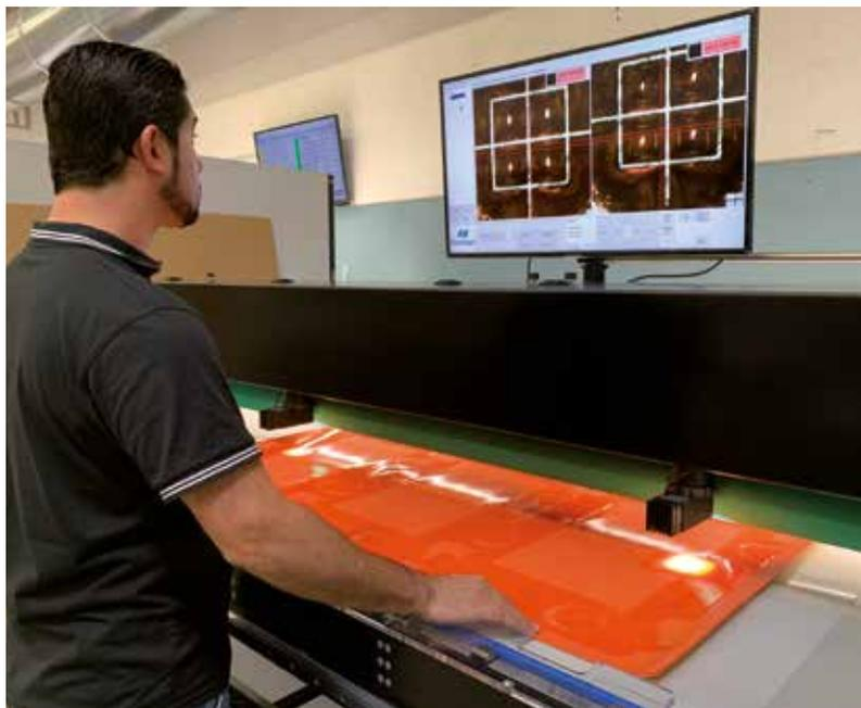
Questa disposizione "rigida" dei punti è anche la causa dei limiti stessi della flexo. ProjectBlue nasce dall'idea di eliminare il retino convenzionale mediante una disposizione "più libera" dei punti. Grazie al sistema Kodak Flexcel NX la forma del punto è assai più stabile di qualsiasi altra lastra e consente di stampare alte luci morbidissime. Inoltre, l'eliminazione della rosetta consente, soprattutto sul cartone ondulato, di mascherare il fuori
