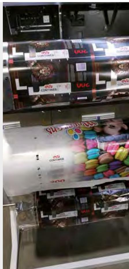
possibilità di montare sia lastre offset che cliché flexo su una singola macchina.
