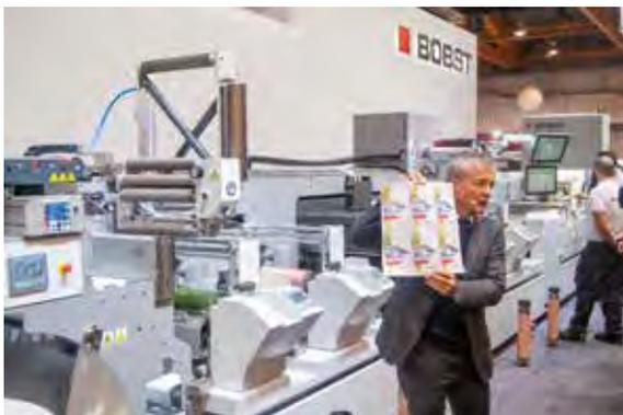
o applicazioni di etichette ad elevato valore aggiunto. I cambi lavoro automatici possono essere effettuati per la stampa flexo, la stampa digitale, la fustellatura senza fermare la macchina. Tutti gli strumenti analogici (cilindri di stampa, matrici di taglio) vengono sostituiti automaticamente. Anche l'eliminazione degli sfridi è totalmente automatizzata", commenta Federico D'Annunzio, Program Manager per la stampa ibrida di BOBST.
