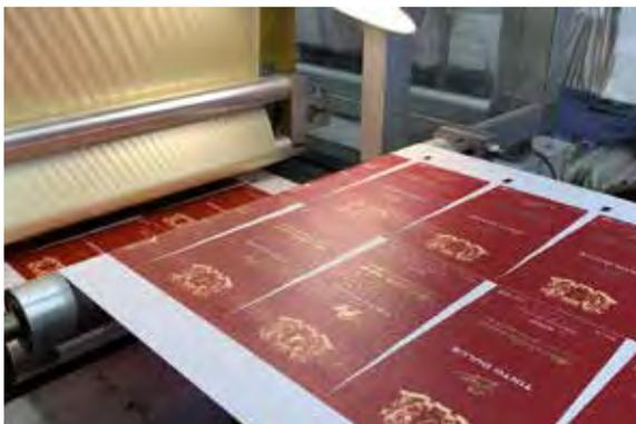
fustellatura e il taglio; offre una perfetta registrazione, attraverso l'Intelligenza Artificiale SmartsScanner (AIS) che regola automaticamente e in tempo reale inclinazione, allungamento e contrazione. MGI JETVarnish 3D Web ha la possibilità di creare diversi spessori fino a 232 micron per un effetto tattile e di goffatura con velocità di produzione che raggiungono i 42m/min.
