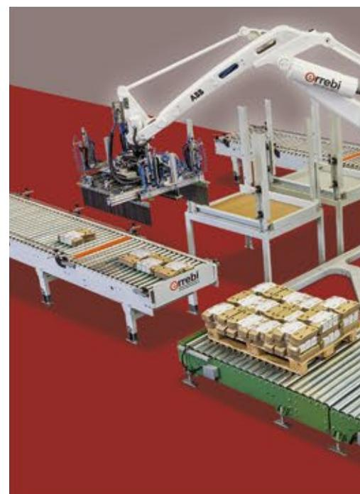
Isola robotizzata di pallets
