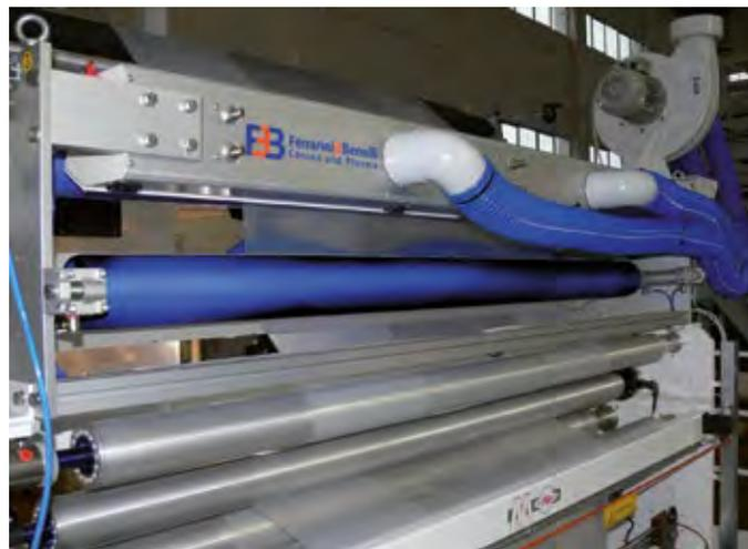
sione in funzione durante la fiera. In Air Plasma: il trattamento plasma favorisce l'applicazione di inchiostri, vernici, collanti e rivestimenti su polimeri, materiali plastici, cartonghi e metalli. Il sistema è composto da un generatore digitale e da una o due torce erogatrici. La larghezza di trattamento di ogni singola torcia è di circa 10 mm.
