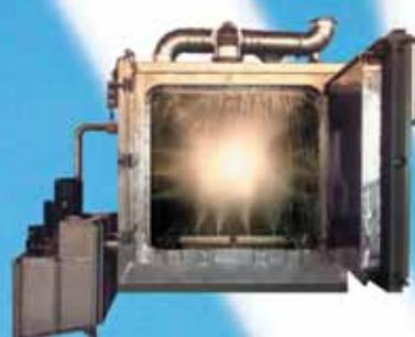
**LAVAGGIO componenti e cilindri
