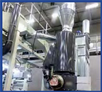
**IMPIANTI MACINAZIONE PER LINEE BOLLA / GRINDING SYSTEM FOR BLOW LINES**
