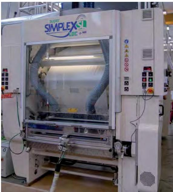
“Tutto l'impianto viene gestito da un unico punto di controllo e le tecnologie sono state opportunamente integrate. Grazie a questa configurazione, la sincronizzazione delle velocità laser-accoppiatrice, la precisione di registro, le funzioni relative alla sicurezza e l'affidabilità nella rimozione dello sfrido sono perfettamente garantite. Il protocollo di comunicazione garantisce infatti produttività, qualità e sicurezza. Parliamo di un processo
