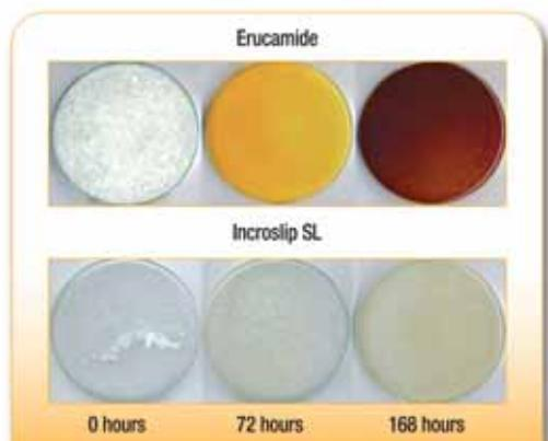
**Figura 2 - Stabilità all'ossidazione: confronto tra Incroslip SL ed erucamide a 120°C (entrambi i campioni contengono 800 ppm 1010 AO)**
