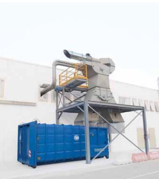
*Sistema di Scarico con Bypass Pendolare*
